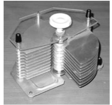
Главное свойство конденсатора, на котором основано его применение – накапливать электрический заряд.
