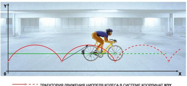
———— ТРАЕКТОРИЯ ДВИЖЕНИЯ НИППЕЛЯ КОЛЕСА В СИСТЕМЕ КООРДИНАТ **ХОУ**———— ТРАЕКТОРИЯ ДВИЖЕНИЯ ОСИ КОЛЕСА В СИСТЕМЕ КООРДИНАТ **ХОУ**
